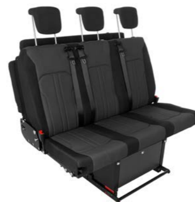
Die SMARTBENCH verfügt über integrierte Sicherheitsgurte und höhenverstellbare Kopfstützen. Eine Schublade unter der Sitzfläche sorgt für extra Stauraum.
