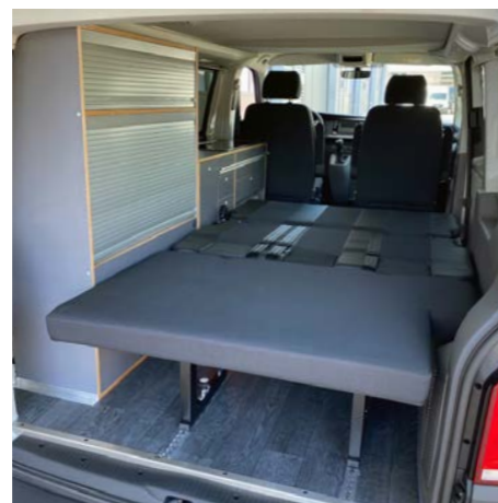
Die SMARTBENCH mit Flexboard bietet eine bequeme Liegefläche. Schrankmodul mit platzsparenden Rolladentüren.
