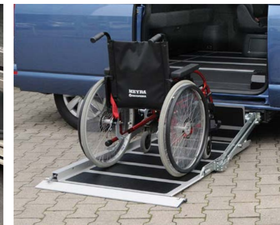
Mit einem optionalen Kassettenlift ist der Campervan auch für Rollstuhlfahrer zugänglich. Ein Personen- & Rollstuhlrückhaltesystem sorgt für Sicherheit während der Fahrt.
